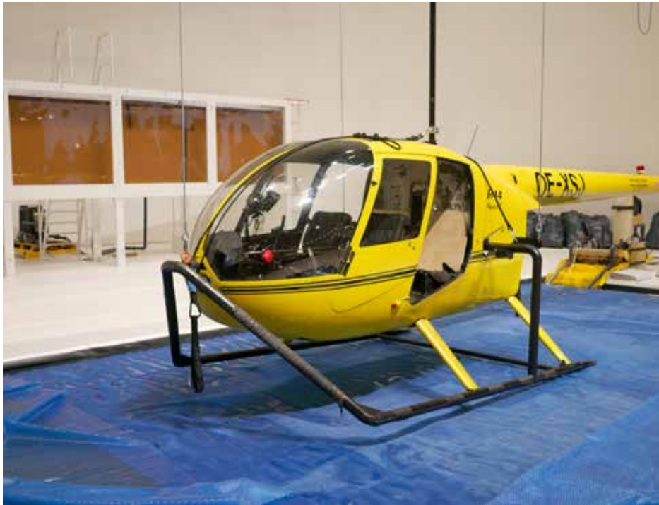
Der einst fluchtüchtige Helikopter über dem Pool: ohne Motor und Rotorblätter, aber mit extra angefertigten Kufen, um Hängepunkte zu schaffen. Eine Isolierfolie verhindert das Auskühlen des Wassers
