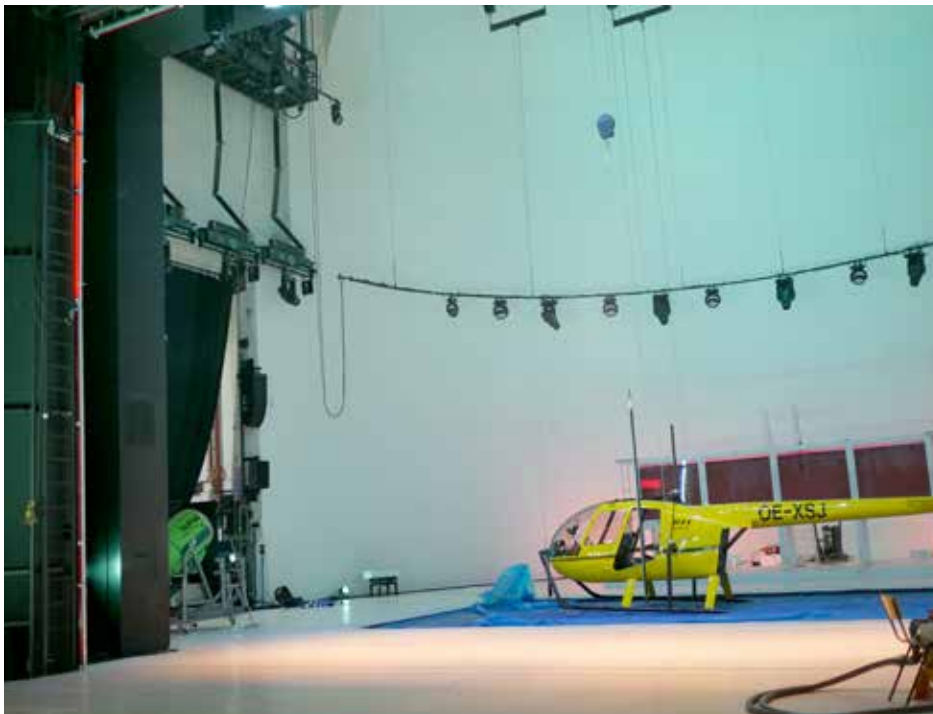
Der Helikopter ist an drei Punkten mit sechs Punktzügen (immer zwei gekoppelt) befestigt, davor hängt die Aerial-Pole-Stange und links steht die als Windmaschine dienende grüne Schneekanone
