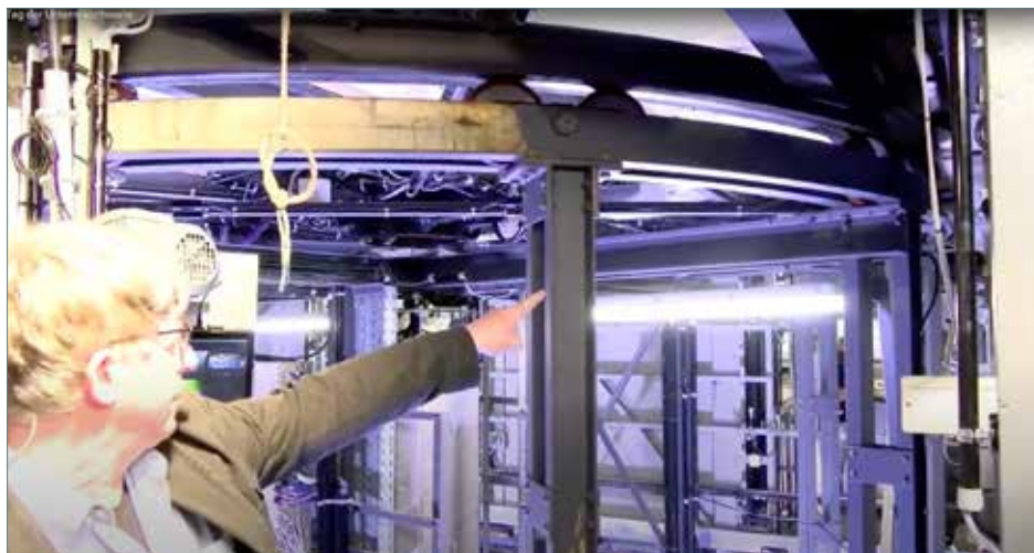
Michael Lüdiger, Technischer Leiter des Grillo-Theaters in Essen, erläutert Details zu Antrieb und Lagerung der Drehbühne. 12 Meter im Durchmesser misst die Essener Scheibe. Foto: Screenshot (DTHG)
