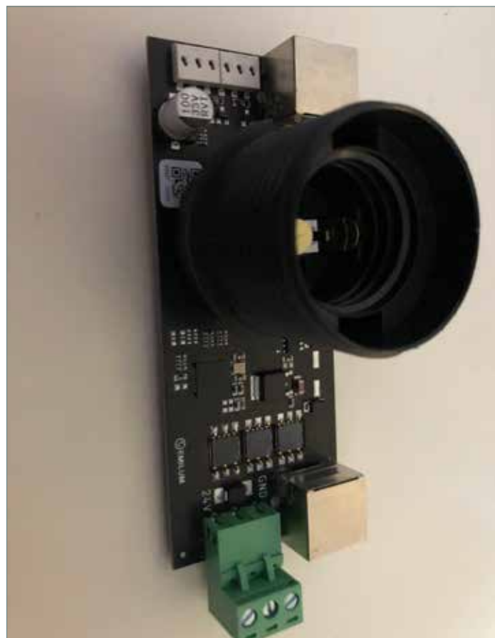
Eine von 1140 Platinen zur Einzelkreissteuerung der Glühlampen über DMX-Signal
