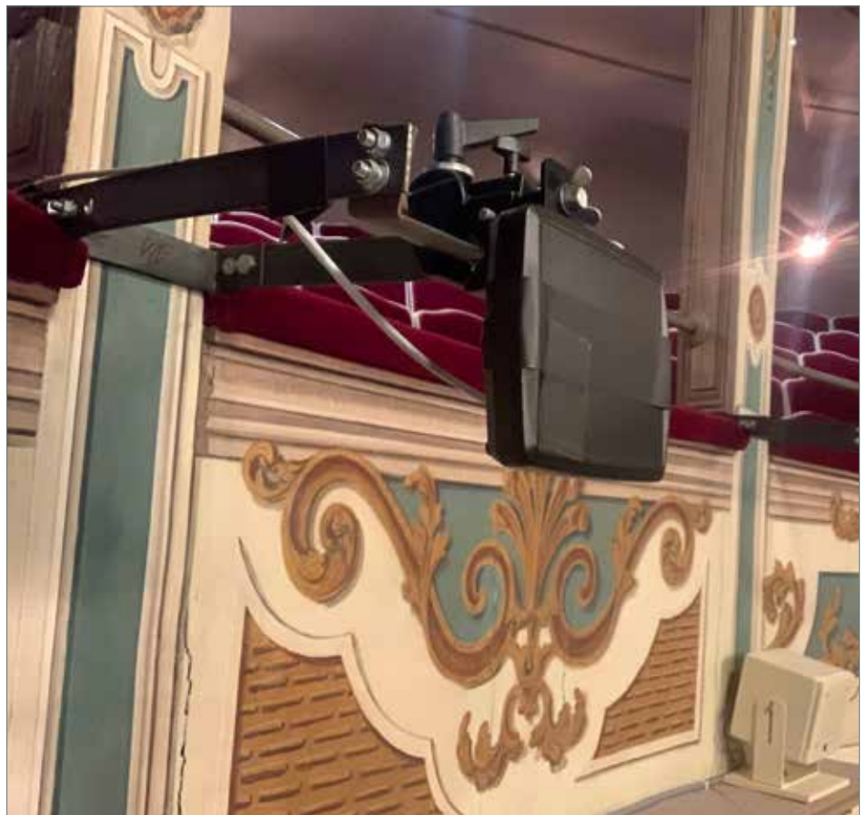
Einer der insgesamt elf Empfänger (Anchor) des Verfolgersystems zackrack Smart: Das Theater Erlangen setzt es nicht nur für die Licht-, sondern auch für die Tontechnik ein. Foto: Kristjan Meyer
