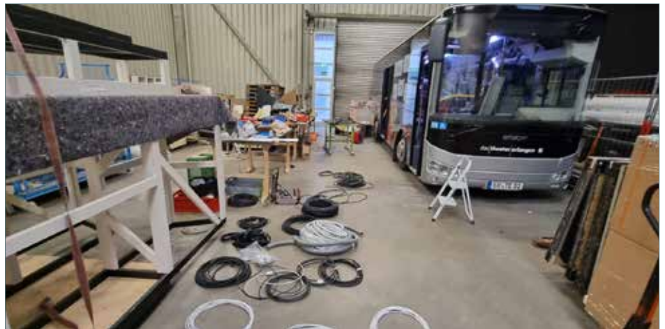
Umbauarbeiten in den eigenen Werkstätten: Der Bus wurde fast komplett entkernt, erhielt zwischen vorderer und hinterer Tür eine „Bühne“ und die entsprechende Technik. Foto: Cedric Sauber
