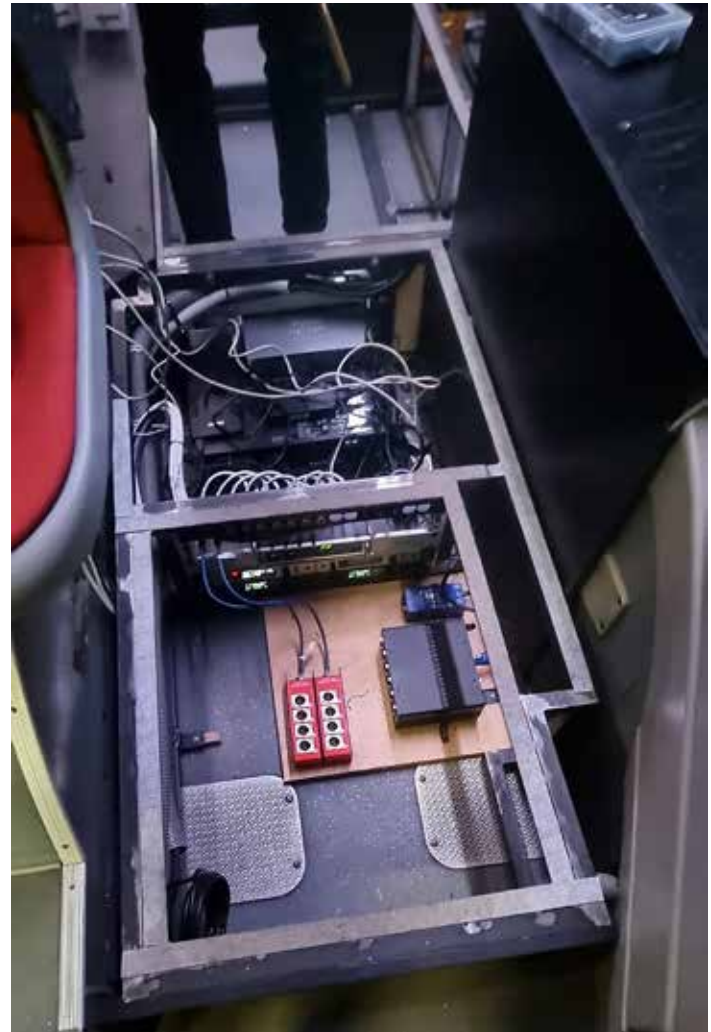
Unabhängiger Bus: vier Solarpaneele auf dem Dach und Lithium-Ionen-Akkus mit aufwendiger Steuerung unter dem Bühnenboden. Foto: Cedric Sauber
