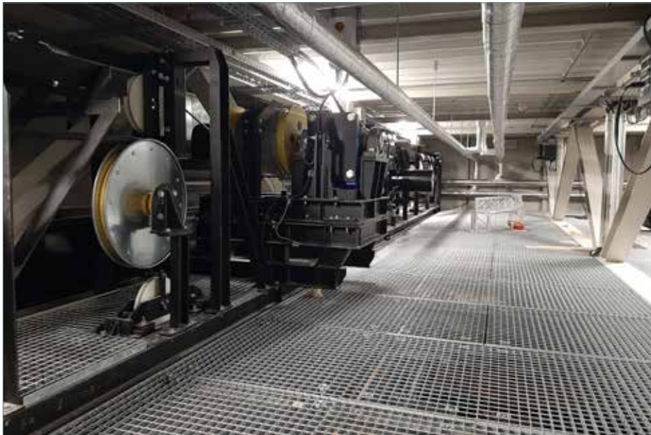
Die Obermaschinerie ist für insgesamt sechs Prospektzüge ausgelegt. Bei Bedarf lassen sich weitere Züge gleicher Bauart nachrüsten. Foto: David Klamroth
