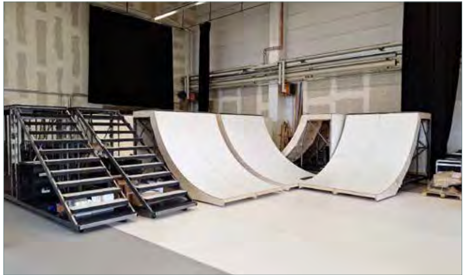
In den Werkstätten der Staatstheater Stuttgart entstand unter anderem die auf einem Stahlgerüst basierende Halfpipe samt Treppen. Fotos: Olaf Lintelmann [2]
